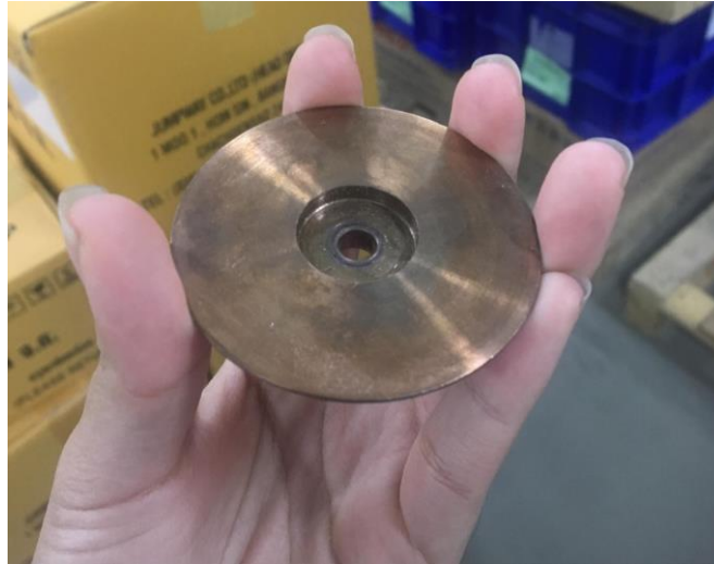
ภาพ 4.7 จาตรองเชื่อมตัวจริงที่ทำการปรับปรุง
