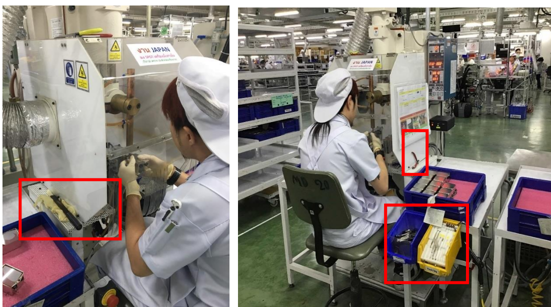
ภาพ 3.10 บริเวณการทำงานที่วางอุปกรณ์สำหรับปรับแต่งเครื่อง Spot Welding ไม่เรียบร้อย
