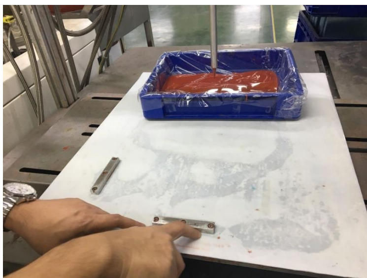
ภาพ 3.6 อุปกรณ์จับยึดชิ้นงานและอุปกรณ์กำหนดตำแหน่งติดตั้งถาดชิ้นงาน
