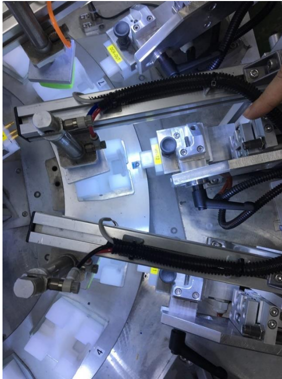
ภาพ 3.16 อุปกรณ์จับยึดชิ้นงานและอุปกรณ์กำหนดตำแหน่งตัวทดสอบค่าทางไฟฟ้า
