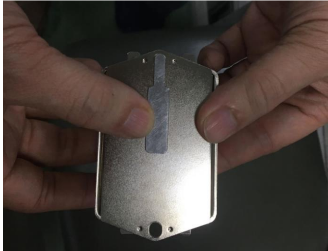
ภาพ 4.3 ตัวล๊อคของอุปกรณ์จับยึดชิ้นงานช่วยปิดประกบฝา และแผ่นสี่เหลี่ยมช่วยฝาแนบ
